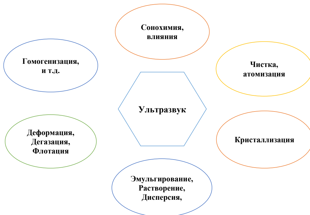
Рис.1. Основные области использования ультразвука в химико-технологических процессах [10]
